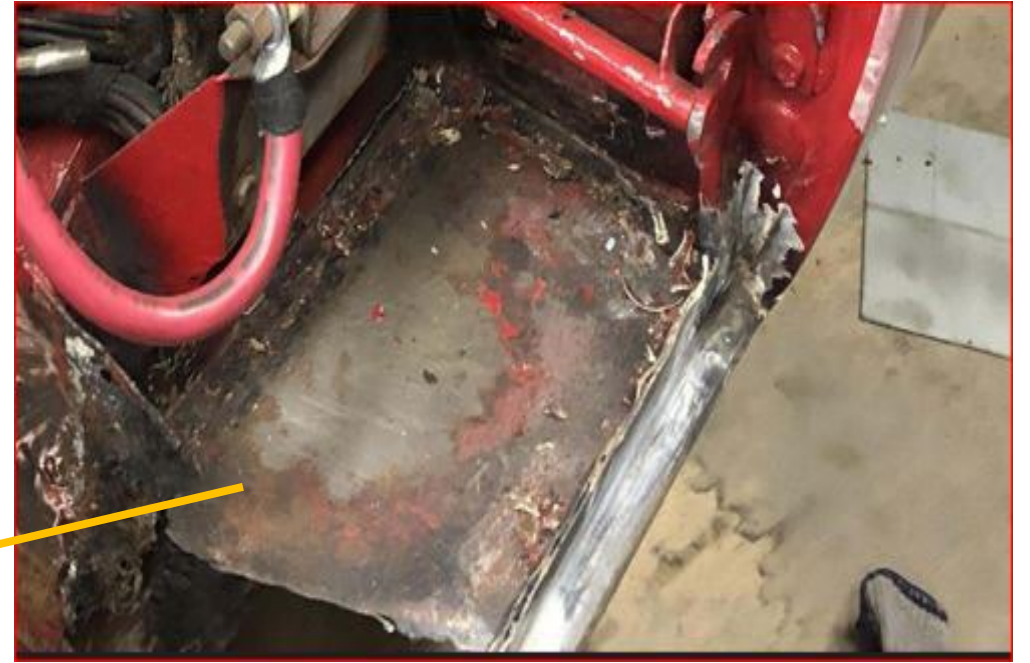
ヒーターBOX下・フロント側腐蝕
